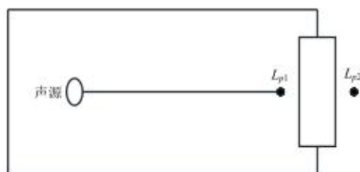
图4-2 室内声源等效为室外声源图例
